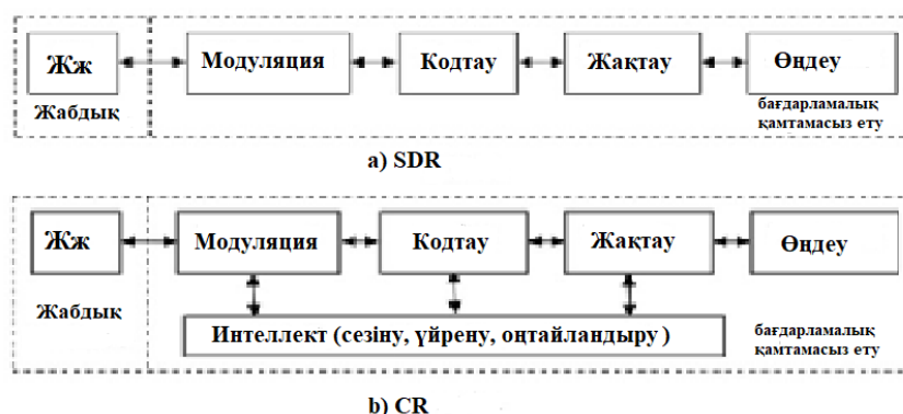
1.2-сурет – Құрылымдық схема: а) SDR және б) Когнитивті радио
